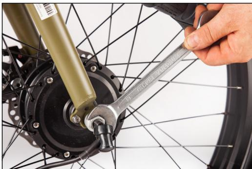
Соедините кабель переднего мотор-колеса с кабелем контроллера. Обратите внимание на стрелки, нанесённые на коннекторы - они должны быть расположены друг напротив друга.
