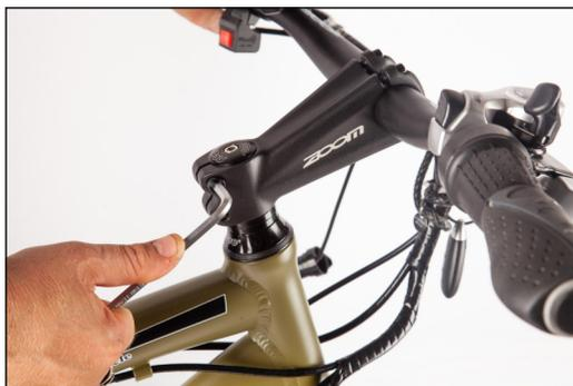
Настройте удобный для вас угол крепления органов управления на руле путём ослабления, корректировки и затяжки их крепежных болтов при помощи шестигранника.
