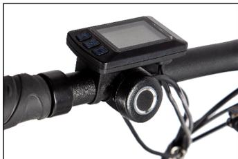
Сканер, установленный на руле велогибрида BigCat Dual, позволяет осуществлять активацию/блокировку электродвигателя при помощи сканирования отпечатка пальца.
