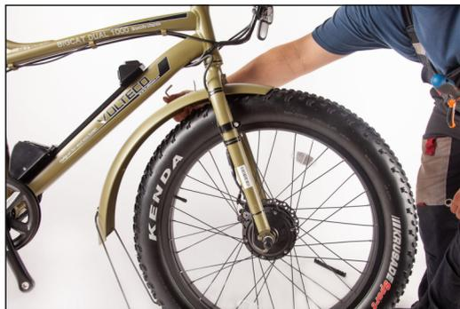
Выкрутите при помощи шестигранника и гаечного ключа крепёжный болт на передней вилке и закрепите с его помощью переднее крыло и багажник в последовательности, показанной на фото.
